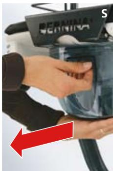
Anschliessend Wasser einfüllen (max. 1,5 Liter). Nur unbehandeltes Leitungswasser verwenden. Den Wassertank verschliessen und wieder bis zum Anschlag einschieben, sodass die Wassertankverriegelung einrastet.
